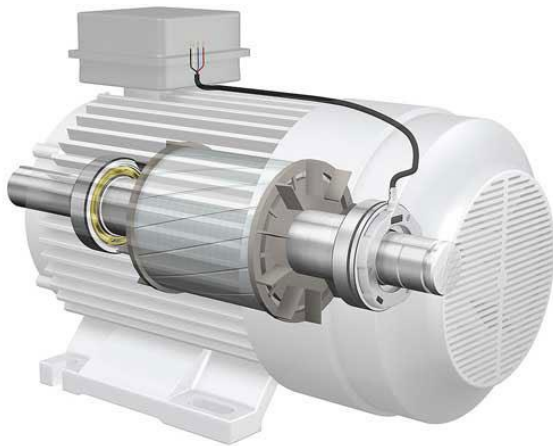
شکل (2) - اندازه‌گیری دمای بیرینگ جهت جلوگیری از آسیب در صورت افزایش بیش از حد دما
